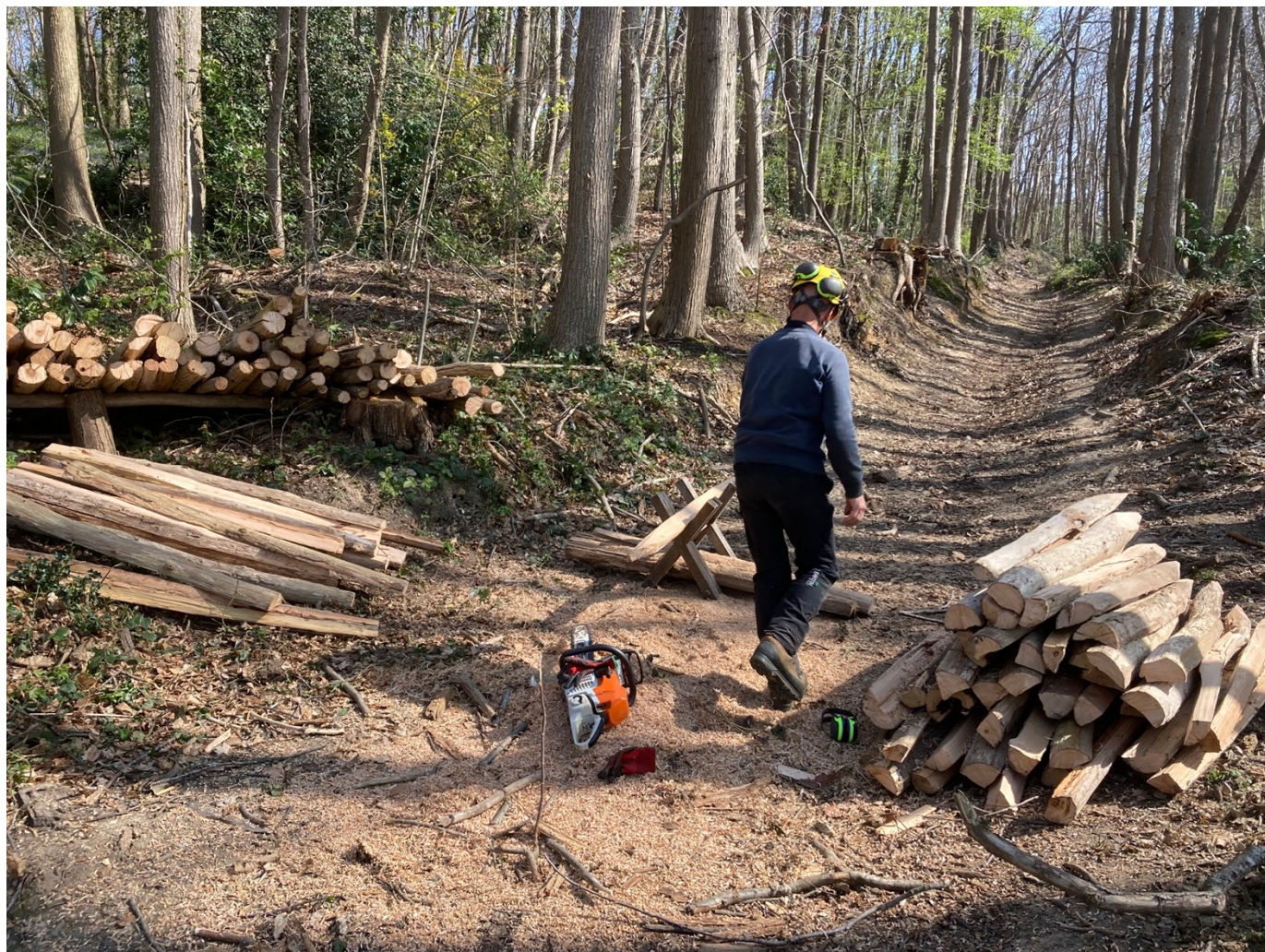
Confection 150 piquets appointés, ronds et fendus de 1,5 m et 10/12 de diamètre en robiniers et châtaigniers
